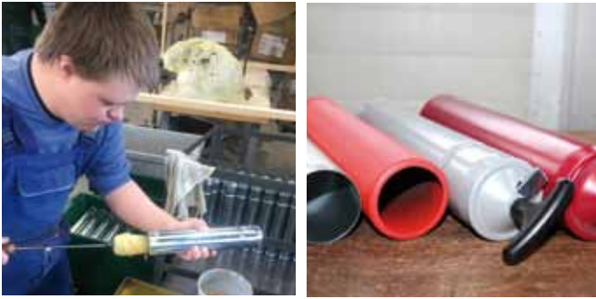
Tom Lindig beim Einölen einer Fettpresse. Er ist einer von neun Beschäftigten der Lobensteiner Werkstätten, die im Metallbereich Fettpressen herstellen.
